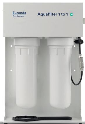
Dispositivo per la produzione di acqua deionizzata per autoclavi, in conformità alla norma EN 13060 (< 15  $\mu\text{S}/\text{cm}$ ). Consente di alimentare una sola autoclave Euronda Pro System. Deionizza mediamente 1 litro d'acqua al minuto.
