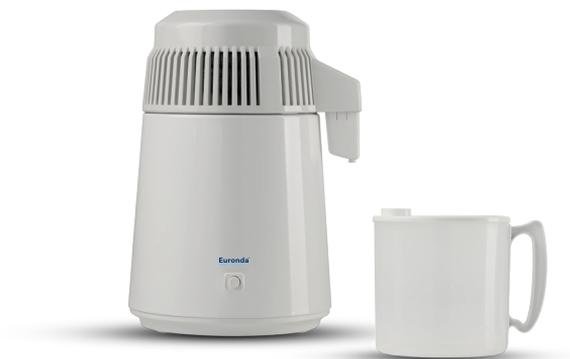
Distillatore d'acqua che permette di ottenere acqua distillata tramite ebollizione e successiva condensazione del vapore. Distilla 0,7 L di acqua all'ora. Capacità 4 litri. Assolve alle prove di sicurezza e di compatibilità elettromagnetica (2014/30/UE) e bassa tensione (2014/35/UE).
